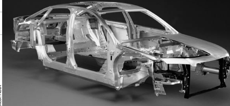
Aluminium-Space-Frame-Karosserie des neuen Audi A8.
