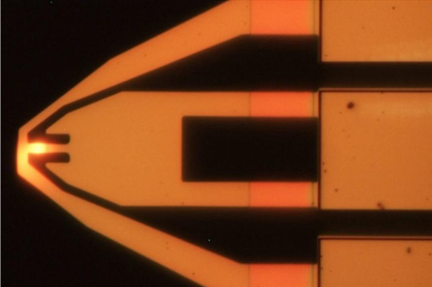
Der NanoFrazor ist im Gegensatz zu herkömmlichen Verfahren in der Lage, dreidimensionale Oberflächenstrukturen mit Nanometerpräzision herzustellen und darüber hinaus auch gleichzeitig zu vermessen.
